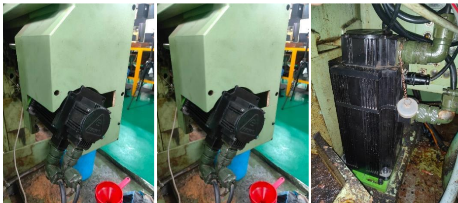
Gambar 4. Motor baru menggunakan motor servo GSK
