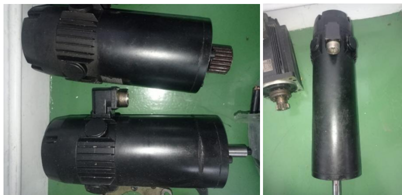
Gambar 3. Motor lama menggunakan motor servo INDRAMAT
